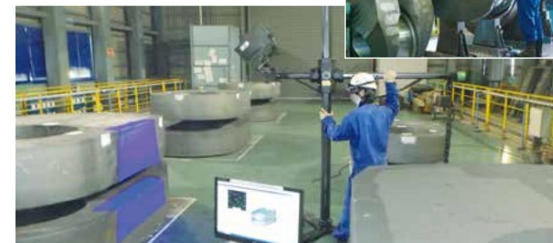
▲ATOSを使用したクランク素材の寸法測定
