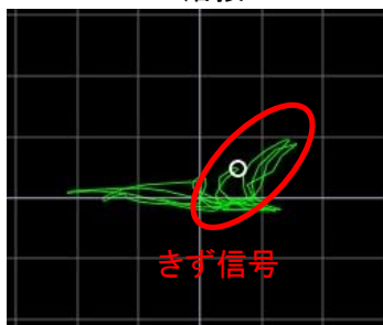
き裂の渦電流探傷結果
